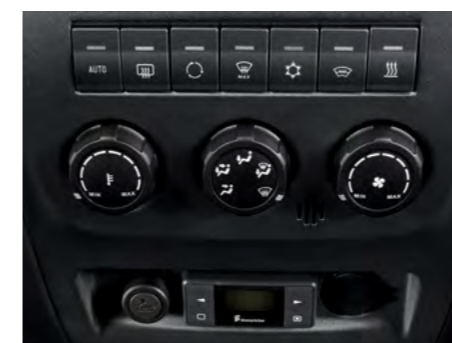
Блок управления системой кондиционирования и отопления
